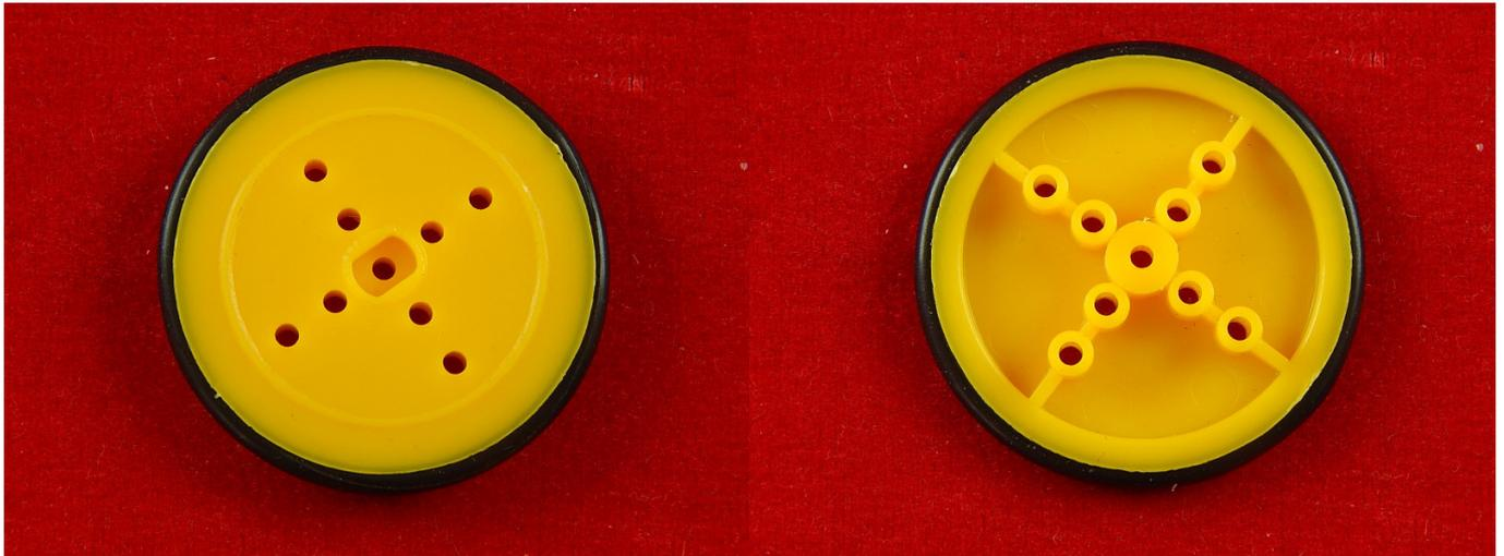
Колесо пластиковое для шасси робота с резиновой шиной
