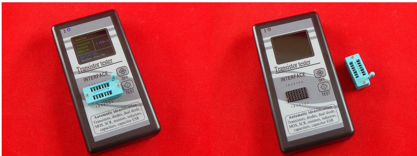
128\*160 TFT цветной дисплей для легкого чтения, может отображать измеренные данные и графику. Все компоненты защищены пластиковым корпусом, удобно носить с собой. Погрешность в 1-3 мм из-за ручного измерения.
