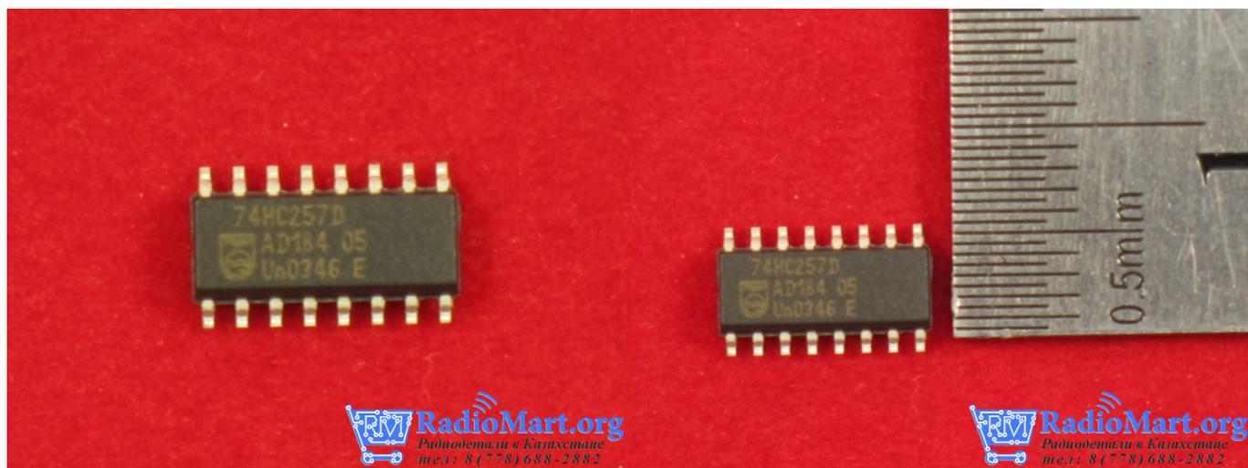
Мультиплексор 74HC257D — устройство, имеющее несколько сигнальных входов, один или более управляющих входов и один выход. Мультиплексор позволяет передавать сигнал с одного из входов на выход; при этом выбор желаемого входа осуществляется подачей соответствующей комбинации управляющих сигналов.
