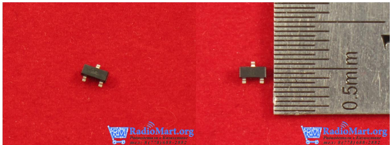
BC847C - SMD Транзистор с NPN переходом в корпусе SOT-23. Маркировка на корпусе - 1G
