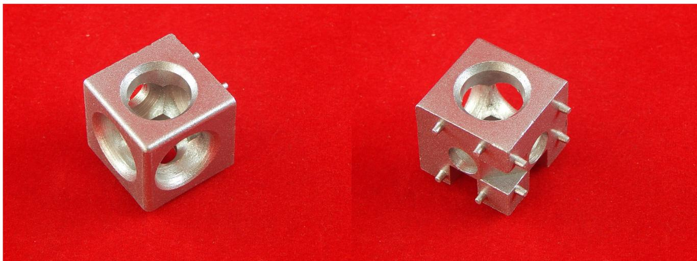
3-х сторонний соединитель 30x30 предназначены для угловых соединений 3-х профилей под углами 90 градусов. Для монтажа изделия необходимо использование метчика, для нарезания резьбы в профиле.
