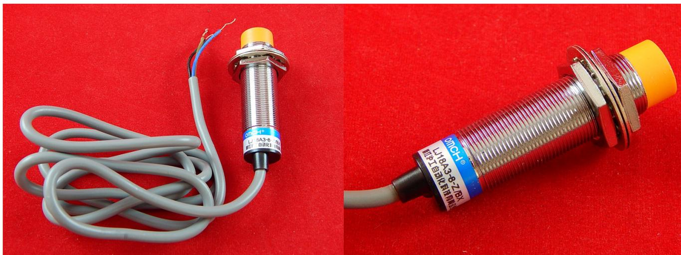
LJ18A3-8-Z/VX используется для контроля положения металлических объектов или расстояния до них, активируется наличием металла в зоне срабатывания. Принцип действия индуктивного датчика основан на изменении параметров магнитного поля, создаваемого катушкой индуктивности внутри датчика.
