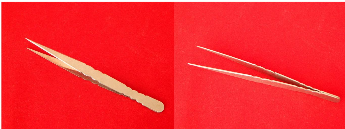
Применяются в электронике и точной механике для удержания микроэлементов при пайке в труднодоступных местах. Изготовлены из нержавеющей стали, устойчивой к износу и воздействию агрессивных сред
