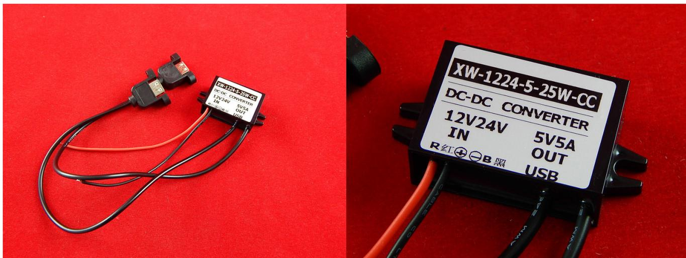
DC-DC конвертер с разъемами USB и контактами для пайки. Компактное устройство для питания отладочных плат с высоким потреблением тока.
