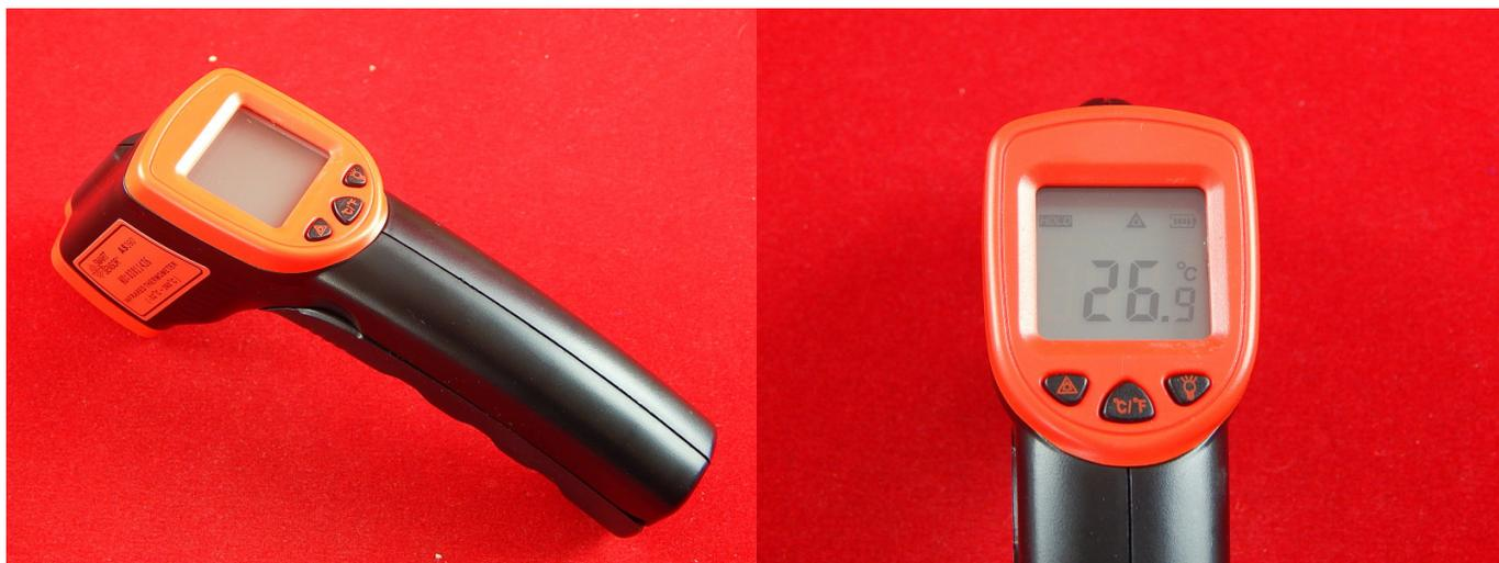
Пирометр - это прибор для бесконтактного измерения температуры тел. Принцип действия основан на измерении мощности теплового излучения объекта преимущественно в диапазонах инфракрасного излучения и видимого света. Компактный цифровой бесконтактный термометр с диапазоном температур от  $-32^{\circ}\text{C}$ .. $+390^{\circ}\text{C}$ .
