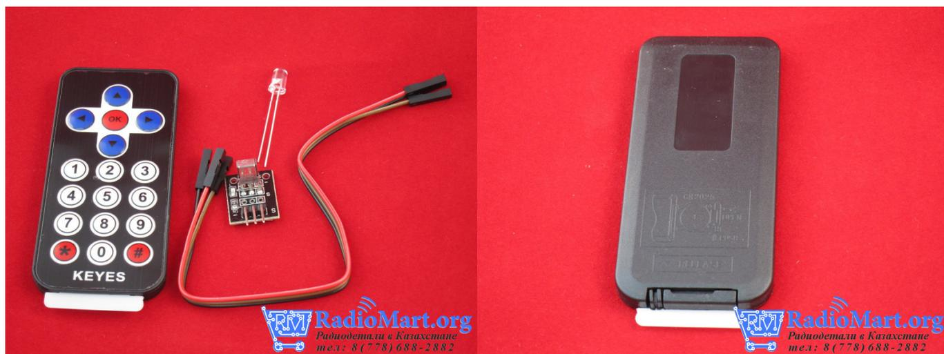
Комплект из инфракрасного пульта дистанционного управления на 17 кнопок и модуля на базе ИК приемника TL1838. Отличный вариант для дистанционного управления проектами на Arduino или Raspberry Pi.
