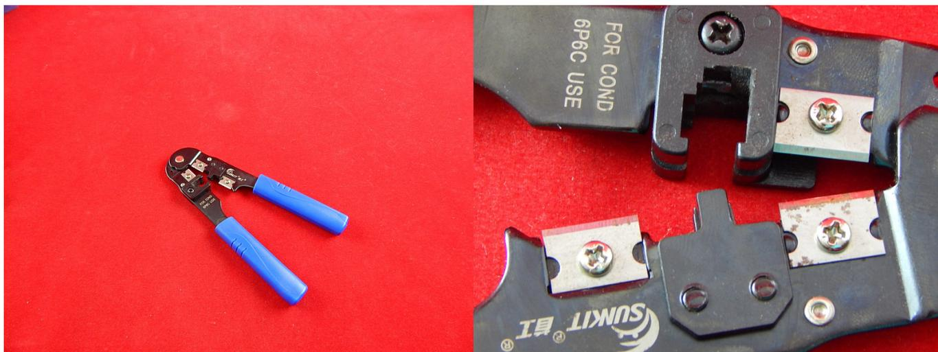
Пресс - клещи или инструмент для обжима коннекторов 6p6c. 6p4c. 6p2c с боковым и прямым ключом, без фиксатора.
