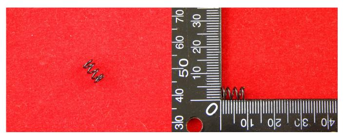
Пружины используются в экструдере и для крепления стола с подогревом, как "прослойка" позволяющая "разцепить" болт с гайкой скрепляющий две детали - например стол и каретку - создать между ними пространство.
