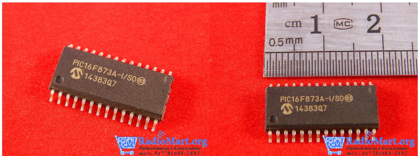
PIC16F873A-I/SO 8-битный микроконтроллер в SO28 корпусе
