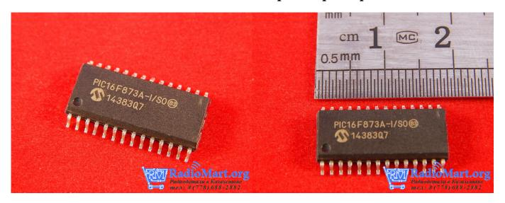
PIC16F873A-I/SO 8-битный микроконтроллер в SO28 корпусе
