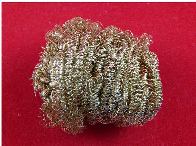
Специальная стружка в металлическом контейнере, применяется для сухой очистки паяльных жал.
