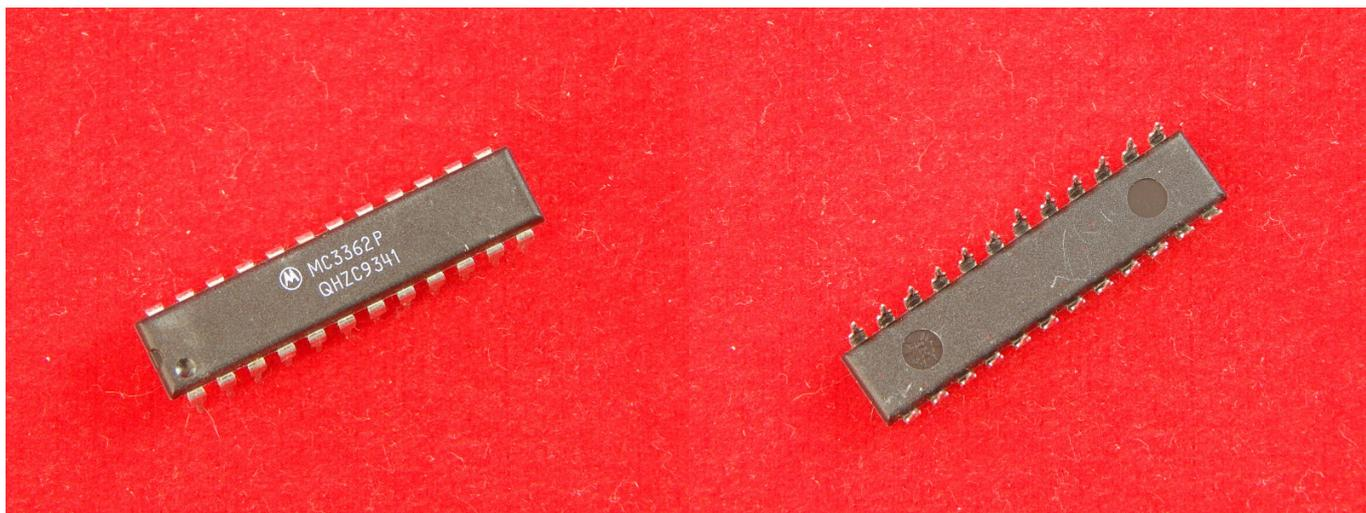
МС3362Р, Маломощный, двухконверсионный FM приемник, 2В...6В, 3.6мА [DIP-24]
