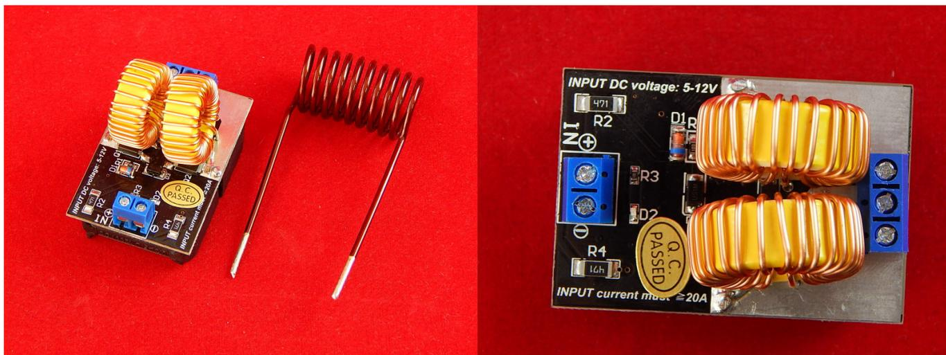
Простой индукционный нагреватель состоит мощного генератора высокой частоты и низкоомной катушки-контра, которая является нагрузкой генератора.
