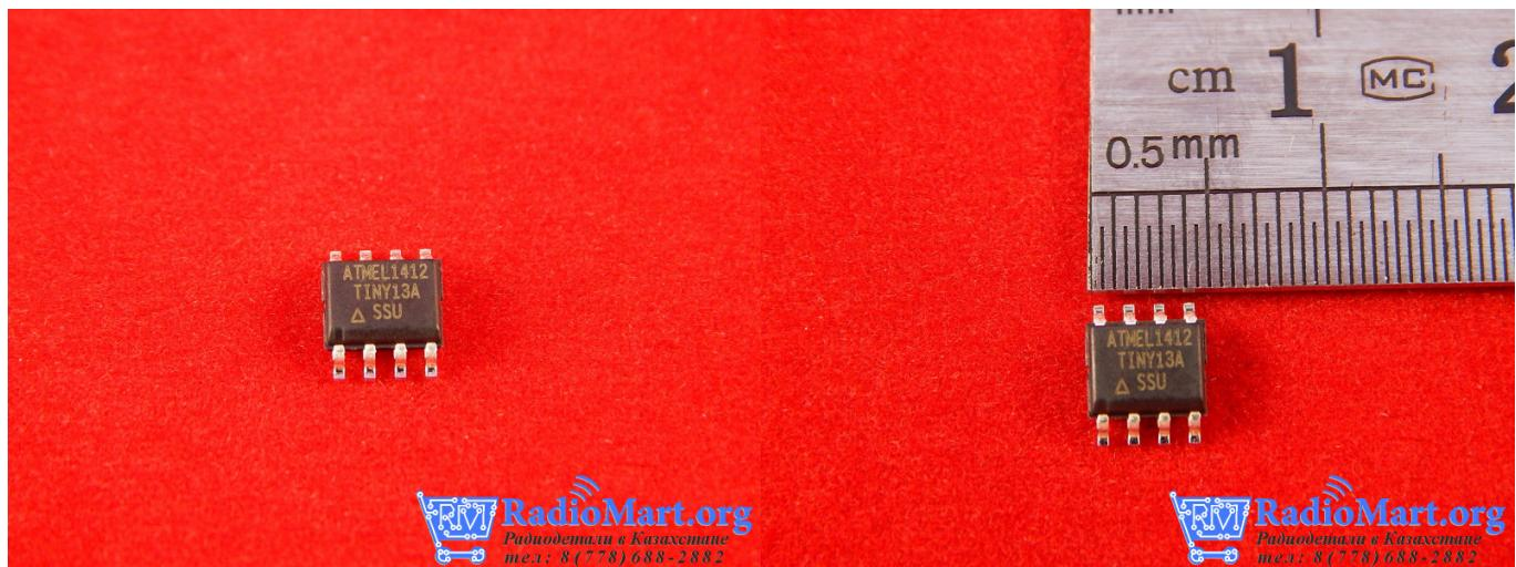
ATtiny13a - 8-битный AVR микроконтроллер, имеющий 8 ножек.
