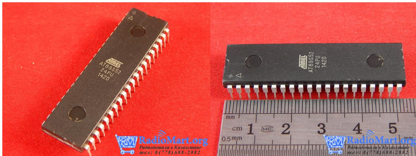
AT89S52-24PU - 8-битный микроконтроллер в корпусе DIP40
