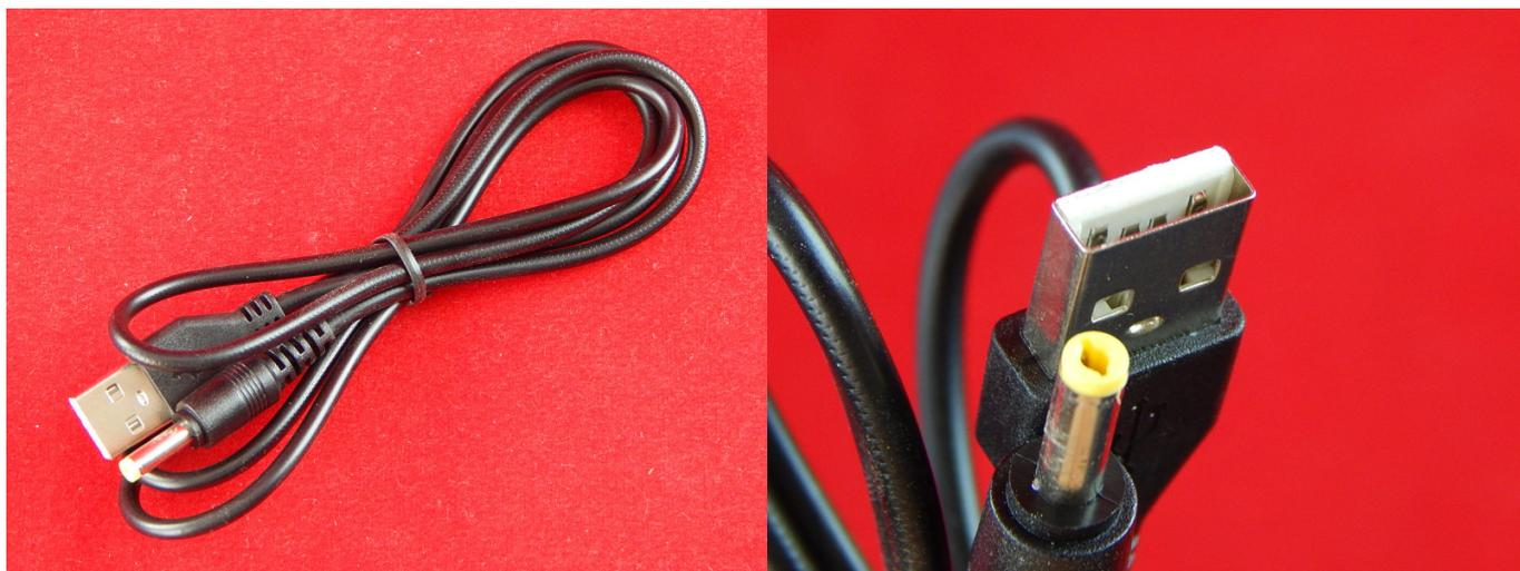
Кабель питания (USB AM - DC 4.0 x 1.7 mm) для одноплатного компьютера Orange Pi.
