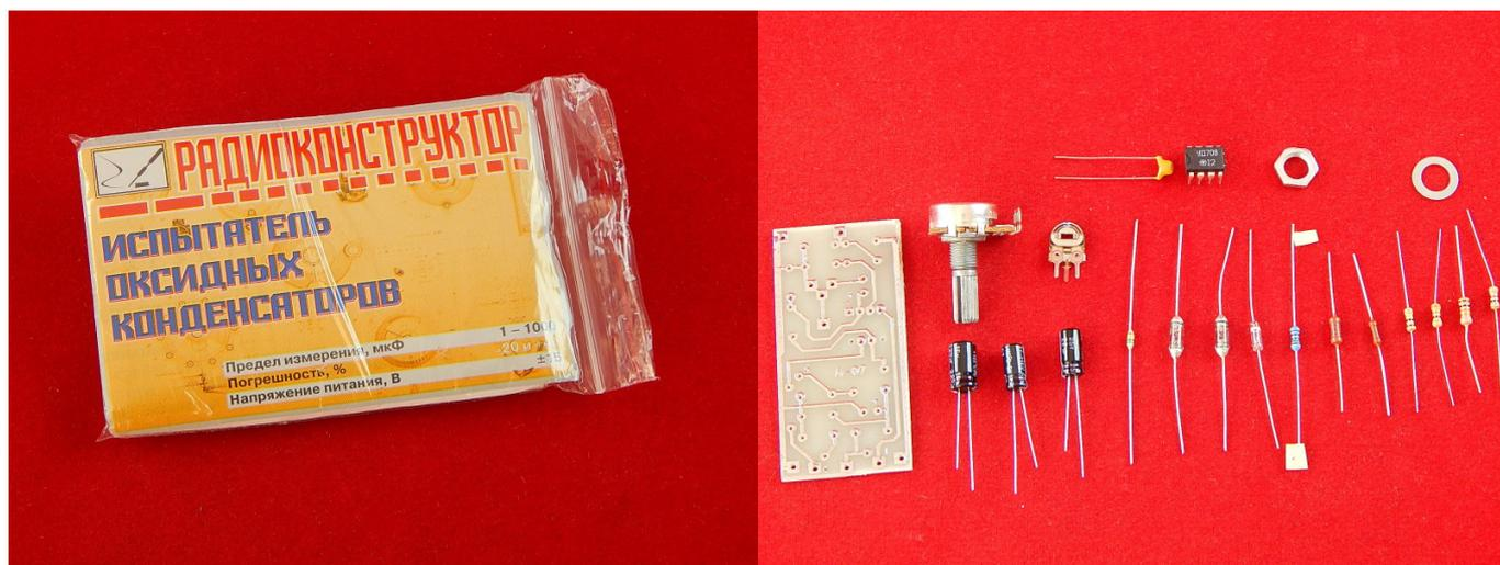
Предлагаемый радиоконструктор позволяет собрать простой испытатель оксидных конденсаторов, который позволяет измерять даже емкость конденсаторов в составе узла, в котором они применимы (т.е. без выпаивания).
