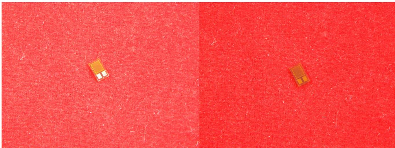
Резистивный датчик давления (тензодатчик, тензорезистор) BF350. Датчик изгиба и деформации BF350 - устройство, физические параметры которого изменяются в зависимости от давления измеряемой среды.
