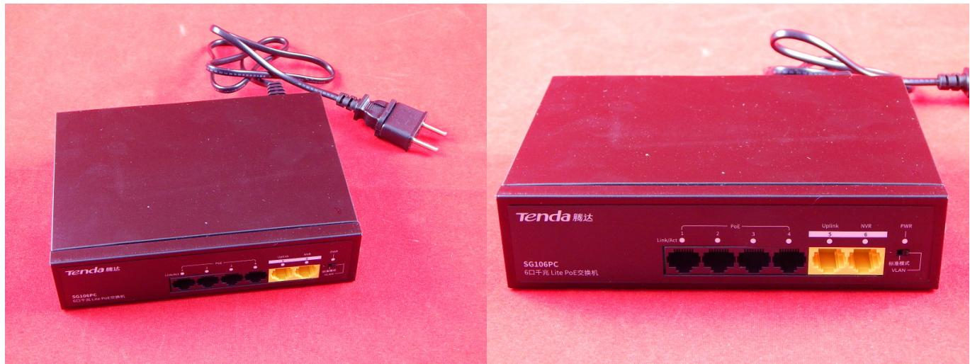
POE Switch используется для подключения 4 POE камер и имеет 2 дополнительных порта для подключения внешней линии либо ресивера.
