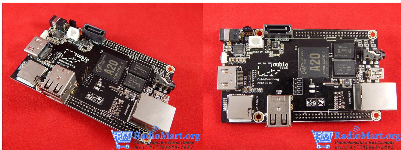
Одноплатный компьютер на базе ARM Cortex A7 Dual-Core (AllWinner A20 SoC)
