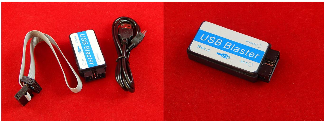
USB программатор USB Blaster для загрузки конфигурации в микросхемы Altera FPGA и CPLD.
