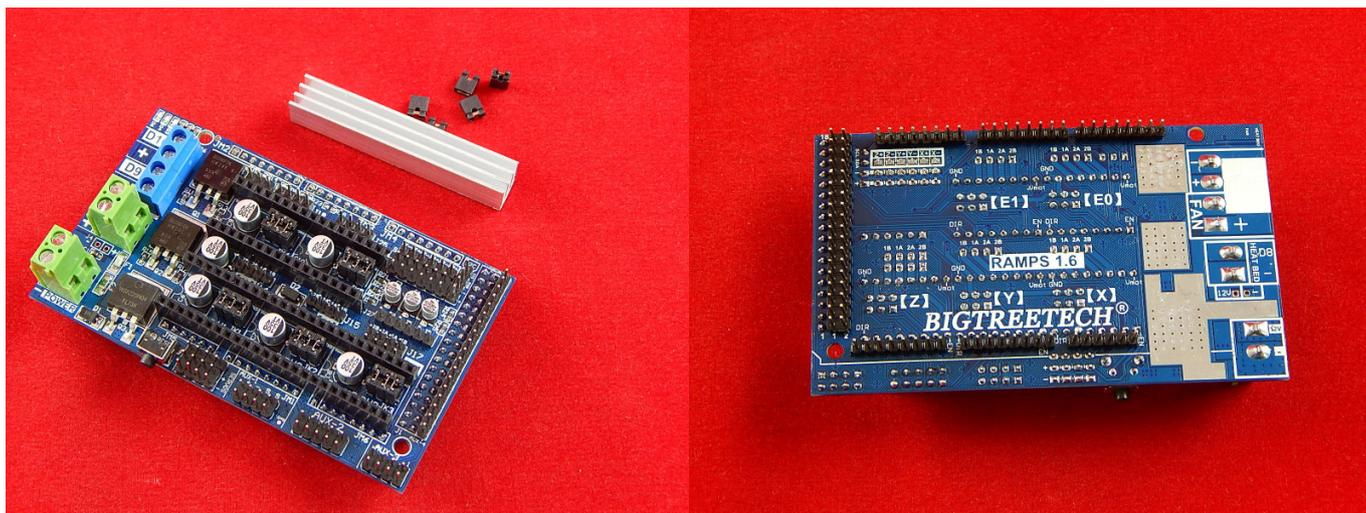
Ramps 1.6 шилд служит для возможности удобного подключения всех необходимых компонентов 3D принтера, управления шаговыми двигателями при помощи драйверов A4988 или DRV8825, используется во многих кастомных 3D принтерах.
