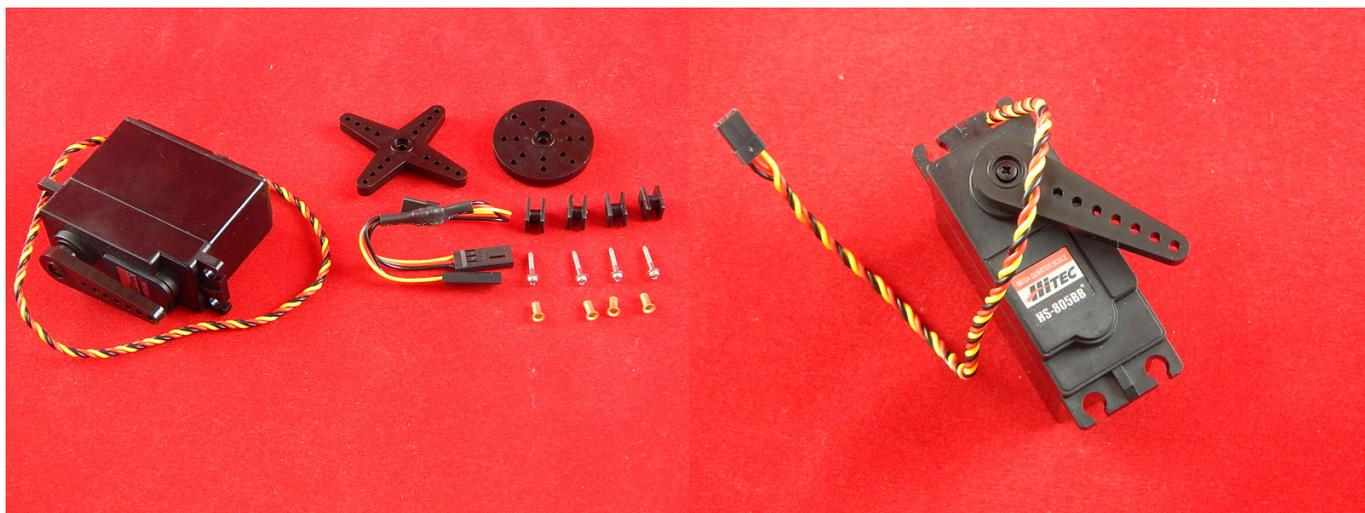
**HS-805BB** - известный как монстр сервопривод, использует высокопрочные нейлоновые шестерни и выходной вал 10 мм с 15-ю зубьями для создания крутящего момента в 24,7 кг\*см. Данный сервопривод может с легкостью использоваться в любом крупном самолете, автомобиле, грузовике или лодке.
