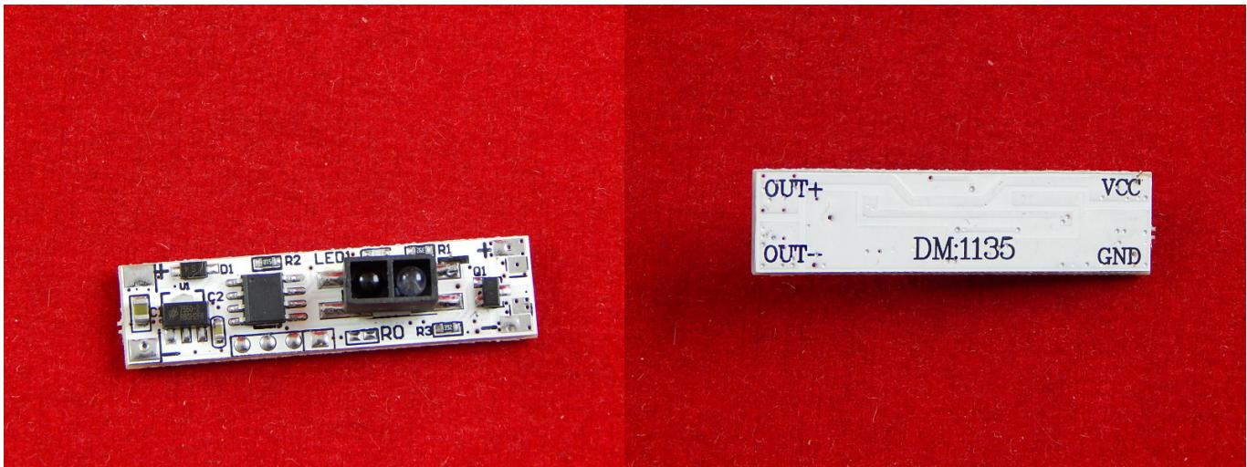
XK-GK-4010A - это датчик движения (сенсор/включатель), имеющий напряжение от 3 до 12 В с током в 3 А. Является инфракрасным и реагирует на движение рук либо на их взмах.
