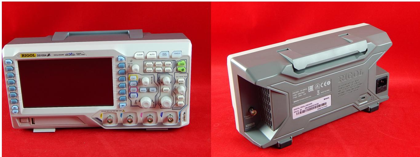
Четырехканальный цифровой осциллограф с полосой пропускания 50 МГц, частотой дискретизации 1 Гвыб/с, 7" дисплеем и записью до 30,000 осцилограмм/с.
