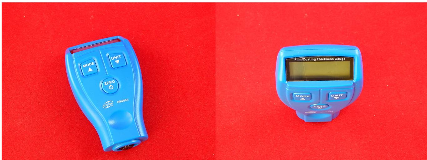
Толщиномер GM200A - для измерения толщины лакокрасочных покрытий.
