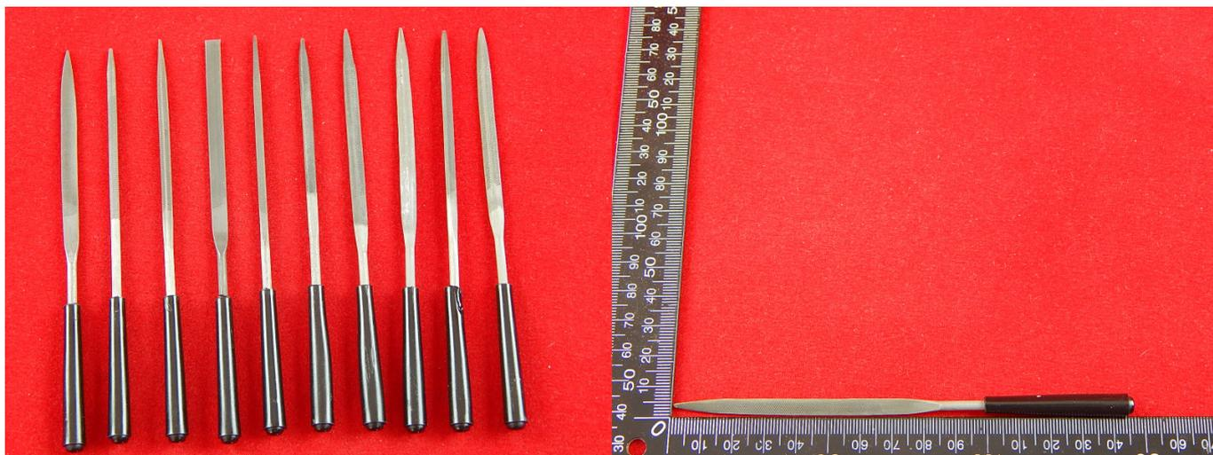
Надфиль изготавливается из высокоуглеродистой инструментальной стали и применяется для зачистки и обработки поверхностей мелких точных деталей.
