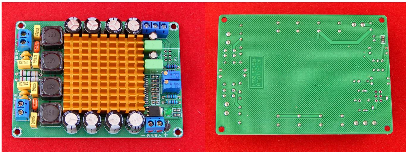
Сtereo усилитель звука ТК2050 2x50 Вт класса T/D на основе микросхем TC2001 и STA505.
