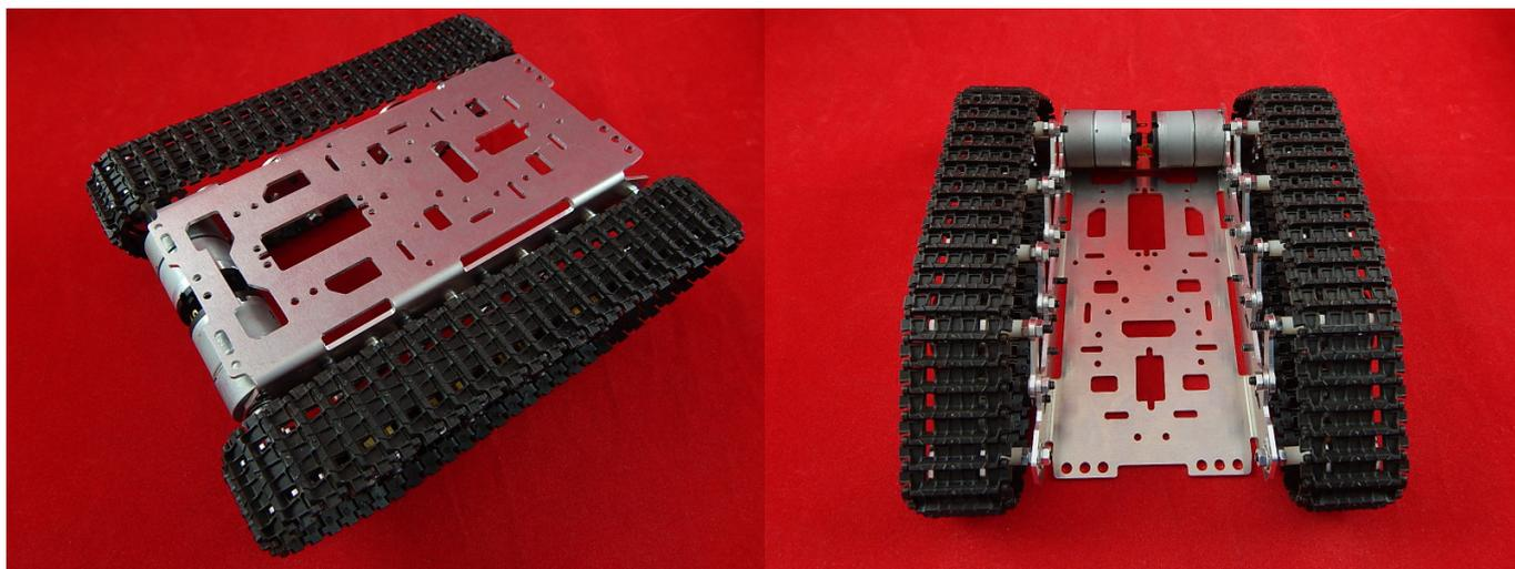
Гусеничное шасси TS100 подойдет для проектирования робота танка на гусеничном шасси
