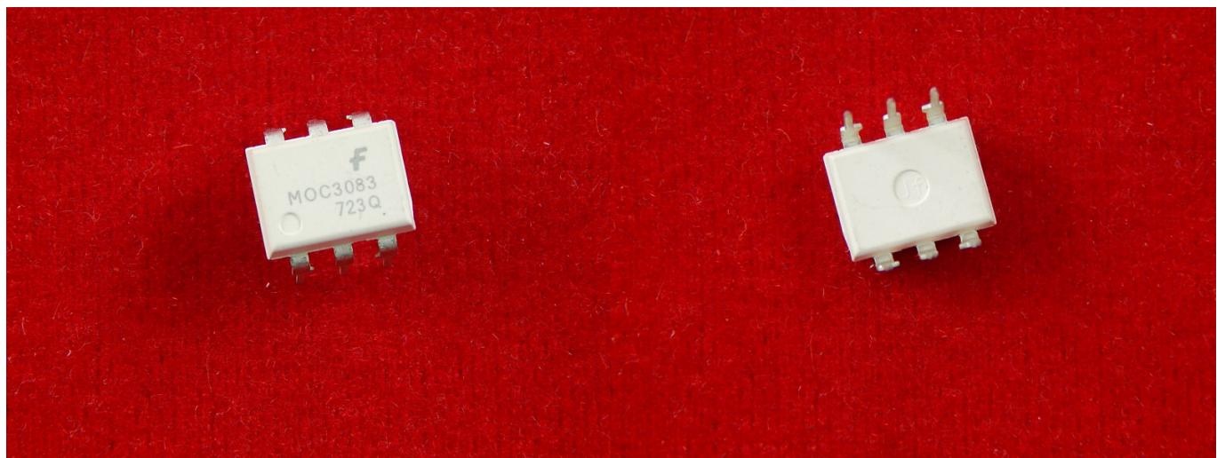
МОС3083М, Оптопара с симисторным выходом 800В, переключение при переходе через ноль [DIP-6]
