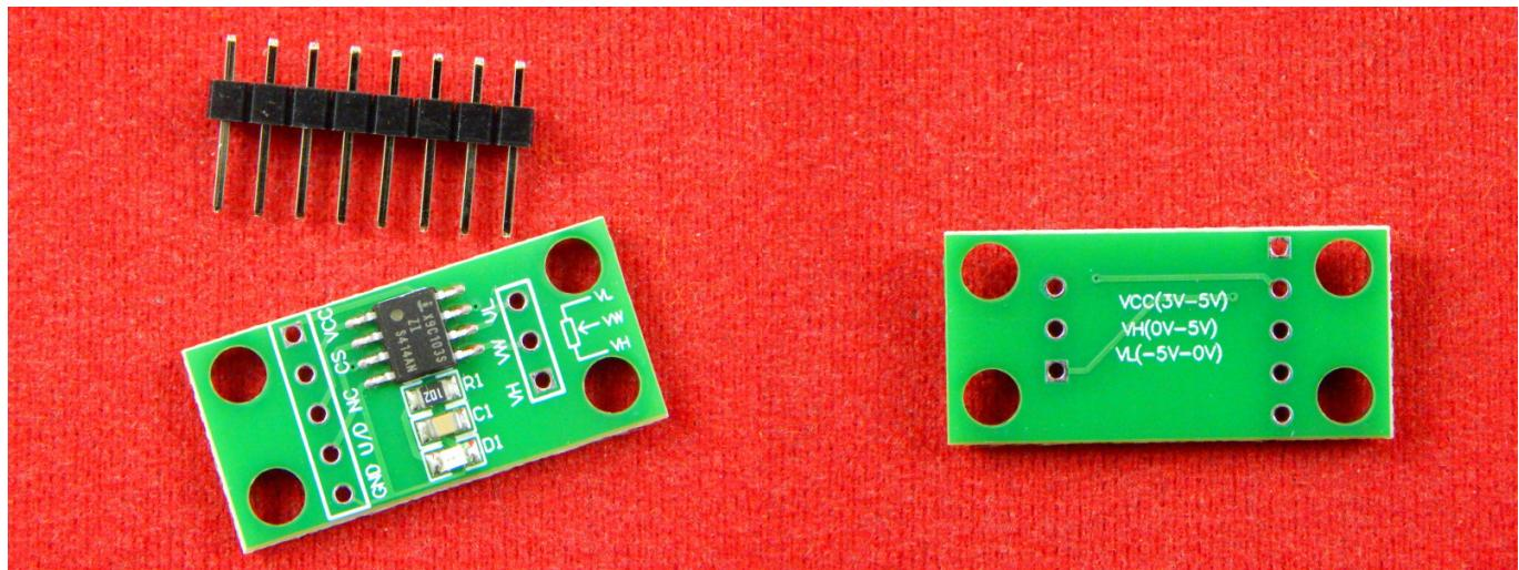
Модуль цифрового потенциометра на чипе X9C103S (до 10кОм). Модуль может запоминать последнее значение сопротивления в EEPROM.
