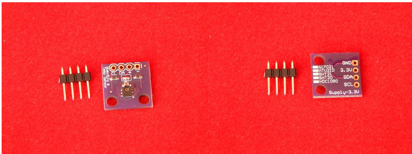
Модуль предназначен для точного измерения влажности и температуры. В датчике применена микросхема HTU21D с интерфейсом I2C, обеспечивающая промышленную точность измерений.
