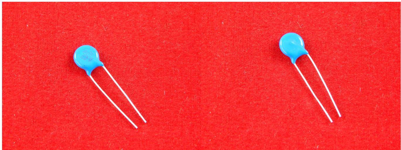
Варистор, или полупроводниковый резистор, - это устройство, электрическое сопротивление (проводимость) которого нелинейно зависит от приложенного напряжения, то есть обладающий нелинейной симметричной вольт-амперной характеристикой и имеющий два вывода.
