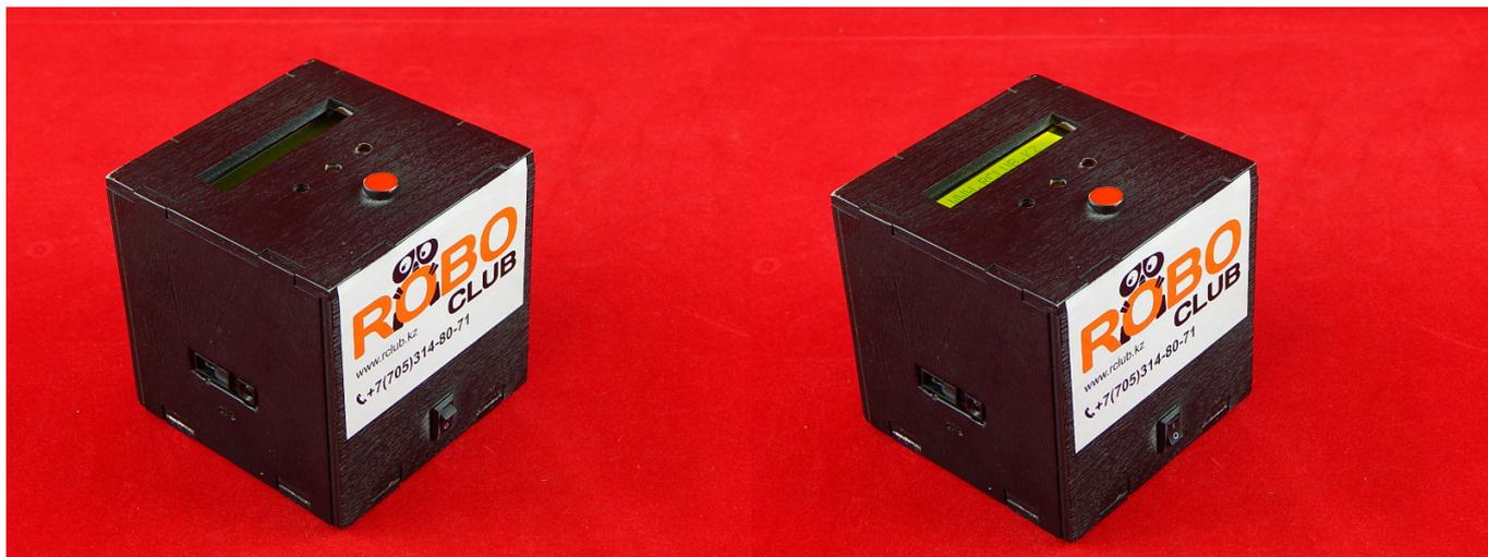
Автоматизированный судья для соревнований по робототехнике (open gate) засекает время проезда робота.
