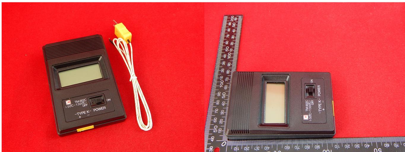
Прибор для измерения температуры ТМ 902С — это инструмент небольшого размера с экраном и кнопкой включения. В комплектацию включена термопара К-типа, которая дает возможность измерять температуру в диапазоне -50...+450°С. Сам термометр ТМ 902С предназначен для измерения температуры в районе -50...+1300°С.
