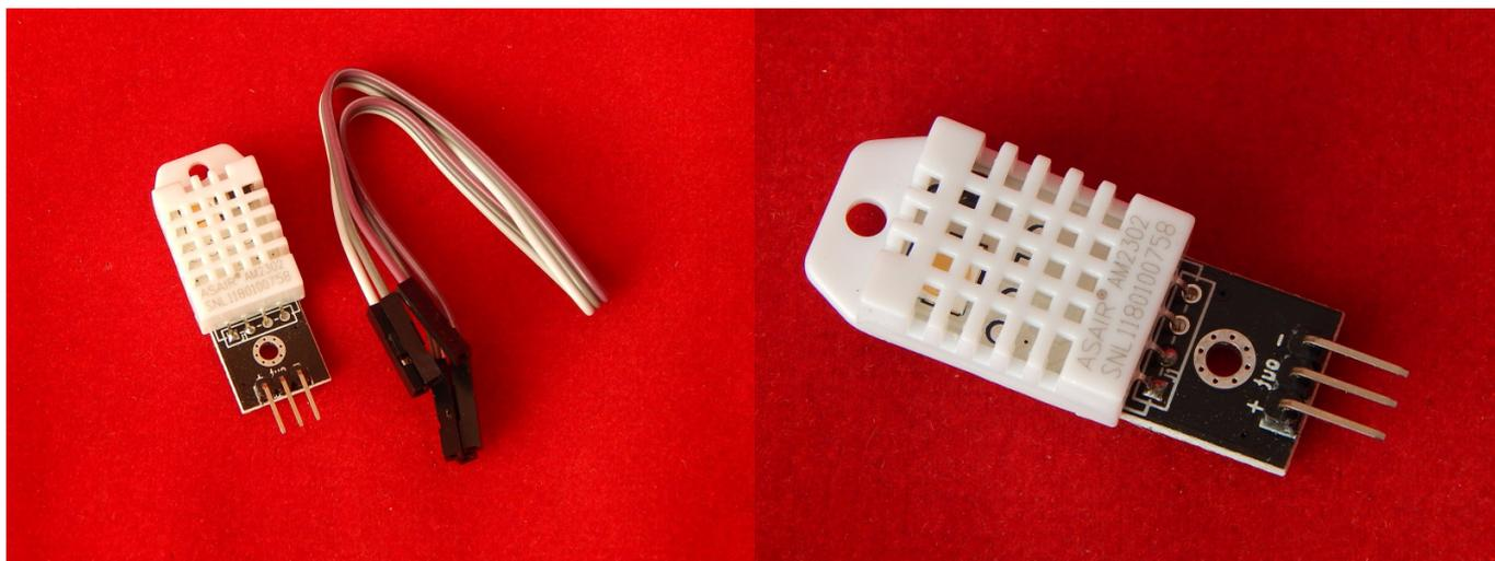
Датчик температуры и влажности DHT22/AM2302 в виде модуля на плате.
