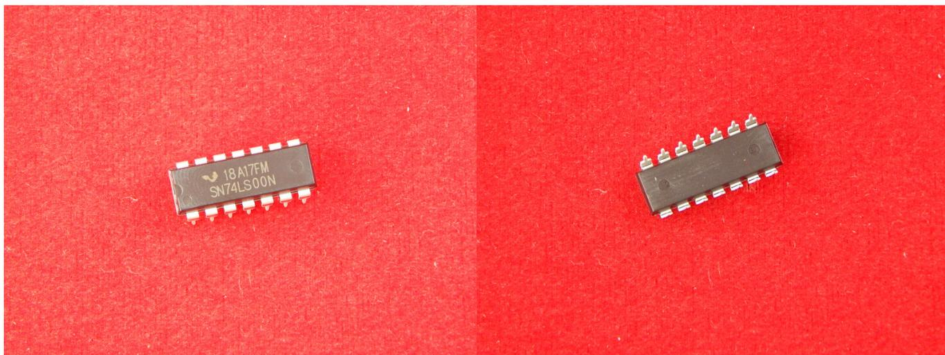
Логическая микросхема SN74LS00N, элемент ТТЛ ИЛИ-НЕ 4 x 2
