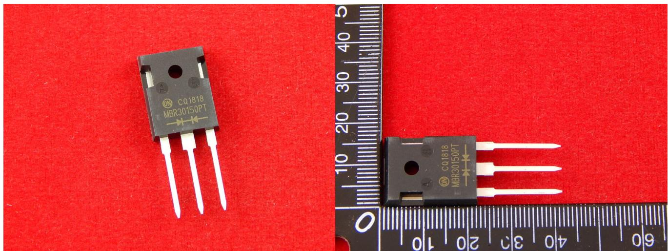
Диод Шоттки сдвоенный MBR30150PT 150V 30A корпус ТО-3Р отличается быстрым временем переключения, низким падением напряжения и рассчитан на ток - 30А и рабочее напряжение до 150V.
