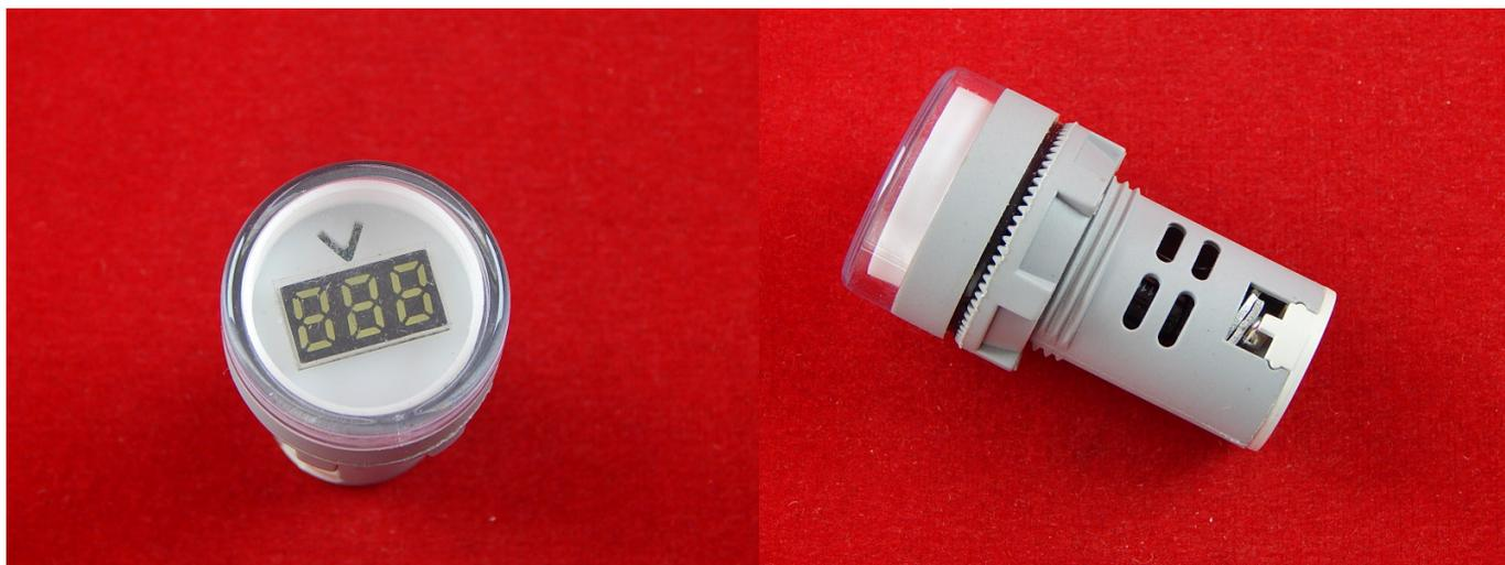
Вольтметр для измерения напряжения в сети переменного тока с диапазоном от 60 до 500 Вольт. Вывод показаний на 3-х разрядный сегментный дисплей. Не требует дополнительного питания.
