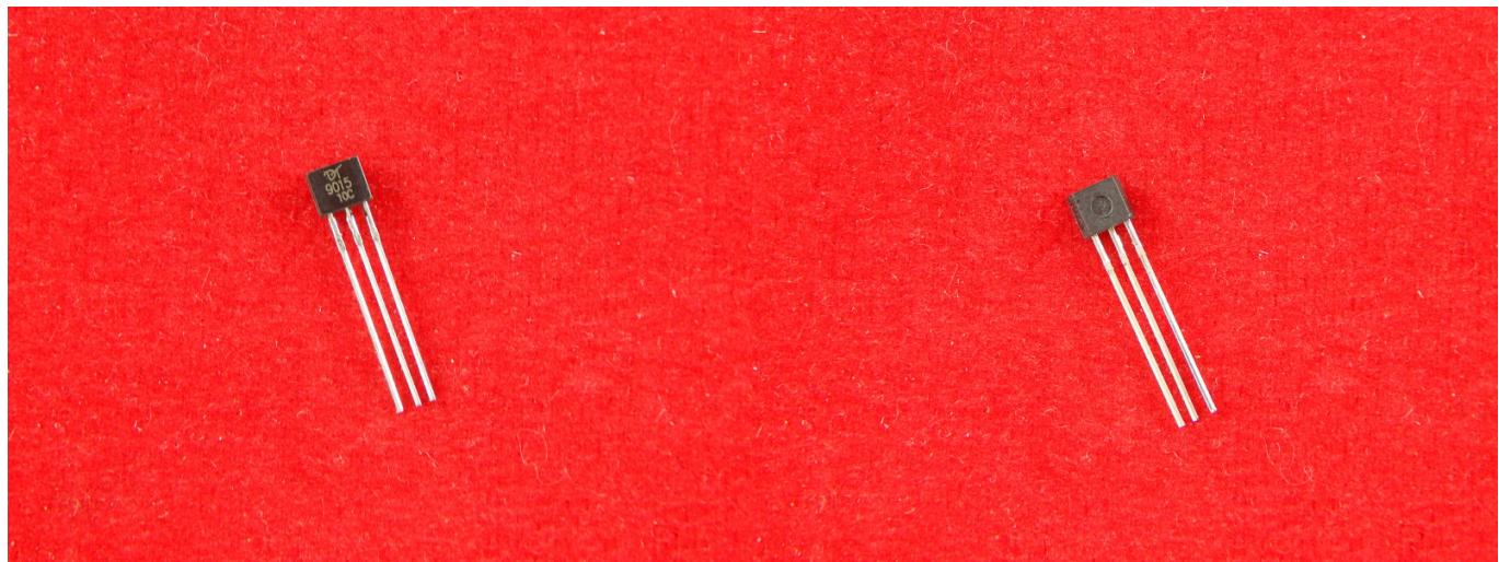
Транзисторы S9015 - кремниевые, сверхвысокочастотные усиливательные, структуры - р-п-р.
