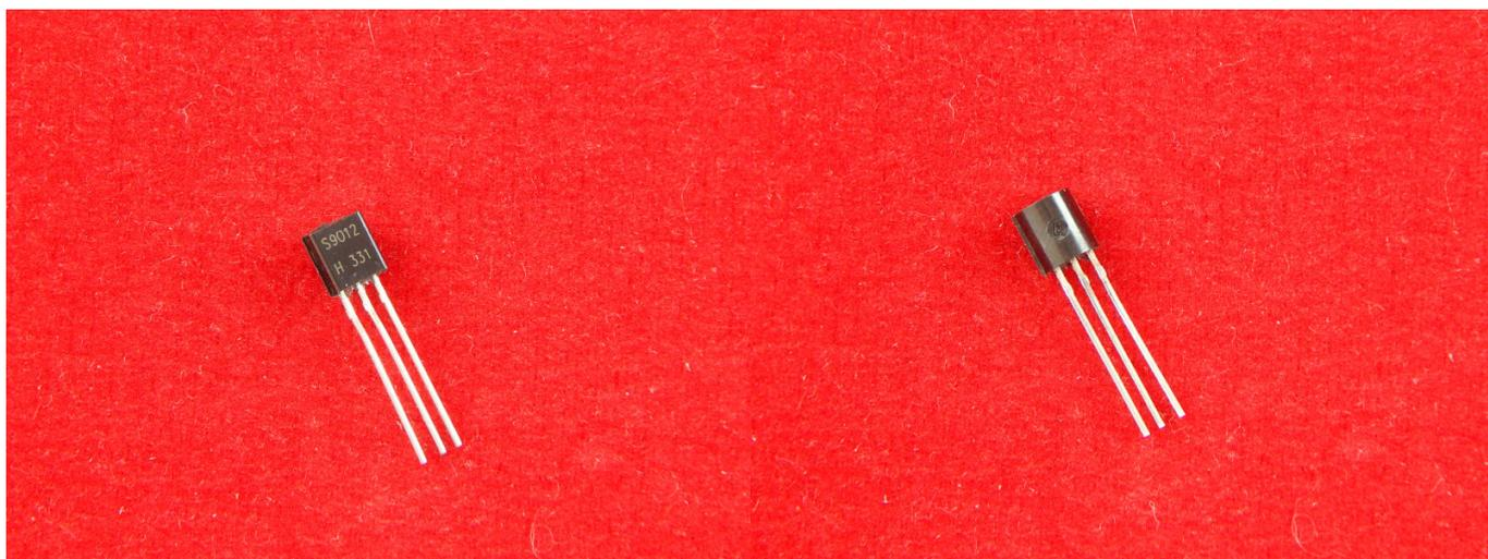
Транзисторы S9012 - кремниевые, сверхвысокочастотные усилительные, структуры - p-n-p.
