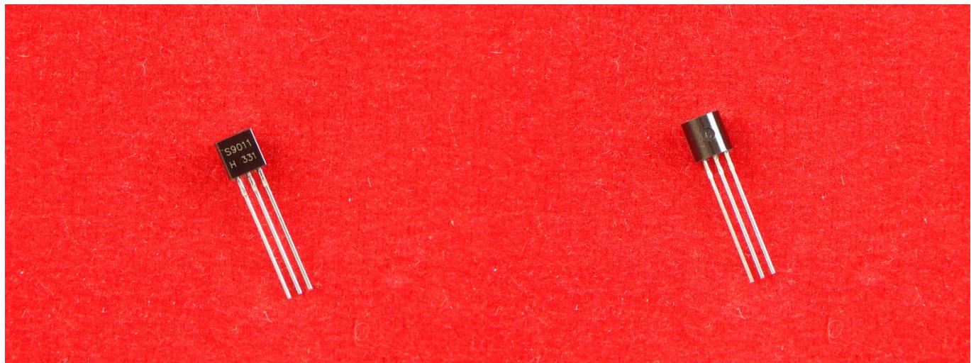
Транзисторы S9011 - кремниевые, сверхвысокочастотные усиливательные, структуры - р-п-р.
