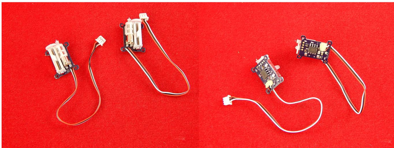
Линейный сервопривод GS-1502 используется в основном для авиамоделей. Существует 2 версии - L и R, отличаются расположением мотора.
