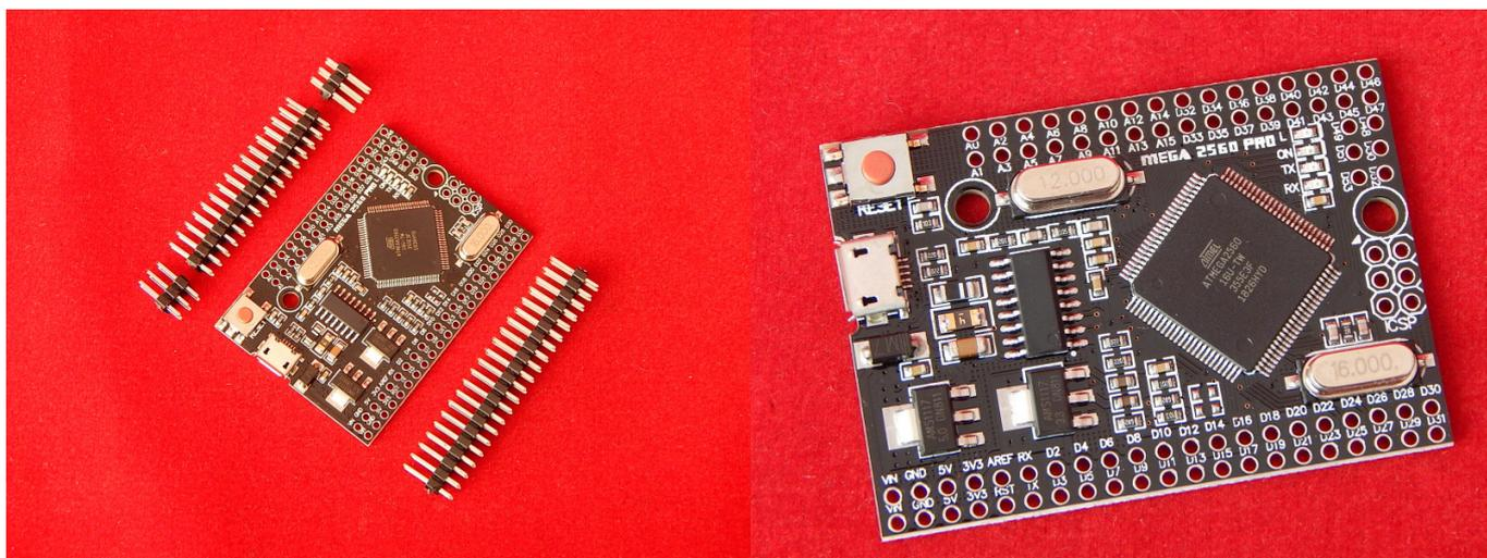
Контроллер **Aduino MEGA2560 Pro** (чип usb CH340) – компактная плата микроконтроллера, базирующаяся на Atmega2560. По своей сути – это упрощенный аналог Arduino Mega.
