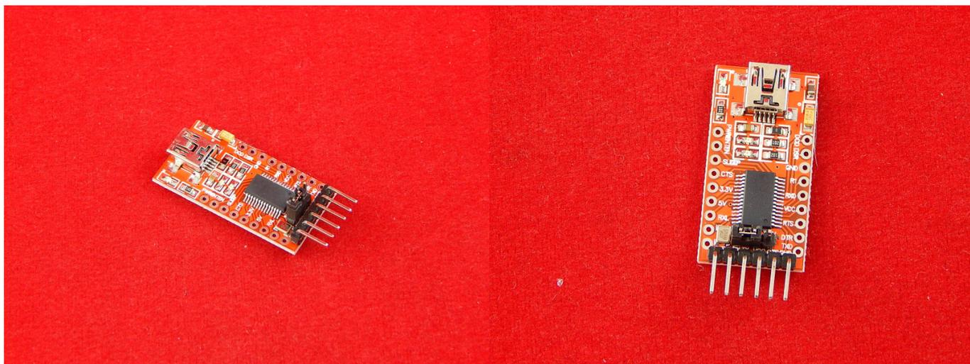
Конвертер USB-TTL — универсальный адаптер, позволяющий работать с USB, как с COM-портом. Основным преимуществом данного переходника является тот факт, что выход UART микроконтроллера можно подключать напрямую к USB-порту компьютера и работать как с USB как с COM-портом.
