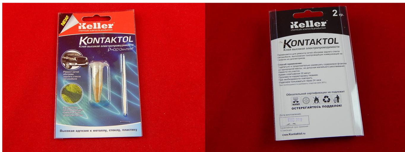
Клей электропроводный "Контактол Авто" 2гр применяется для экспресс-ремонта нитей обогрева заднего стекла автомобиля, а также для восстановления поврежденных дорожек на диэлектрических панелях. Контактол обладает низкой гигроскопичностью. В качестве связующего вещества используются различные синтетические смолы, а токопроводящим наполнителем является порошок серебра.
