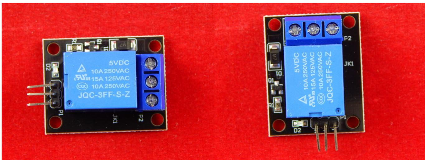
Данный модуль может управляться большим количеством микроконтроллеров, таких как Arduino, AVR, PIC, ARM и так далее. 1-канальная релейная интерфейсная плата. Имеет стандартный интерфейс.
